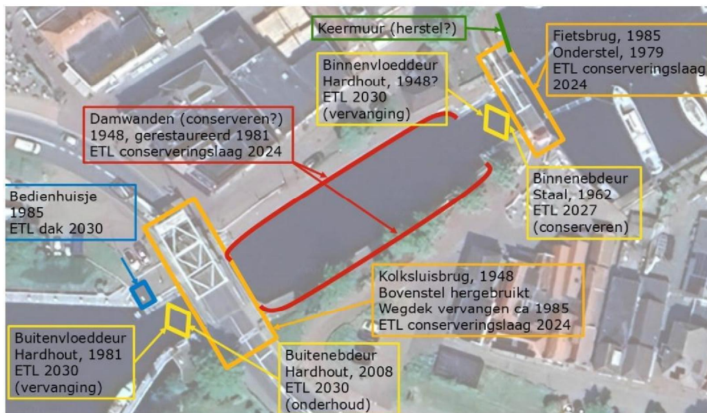
Figuur 4 Overzicht van de onderdelen van de Grote Kolksluis met benaming zoals gebruikt in dit rapport, materiaal, stichtingsjaar en ETL. N.B. de bediening- en besturingssystemen zijn in dit kaartje niet opgenomen.
