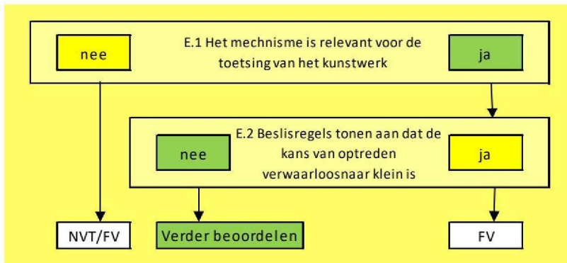
Figuur 3-13 Schema eenvoudige toets bij piping bij kunstwerk (PKW)
